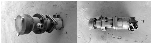
图 2 负压降尘器实物图
